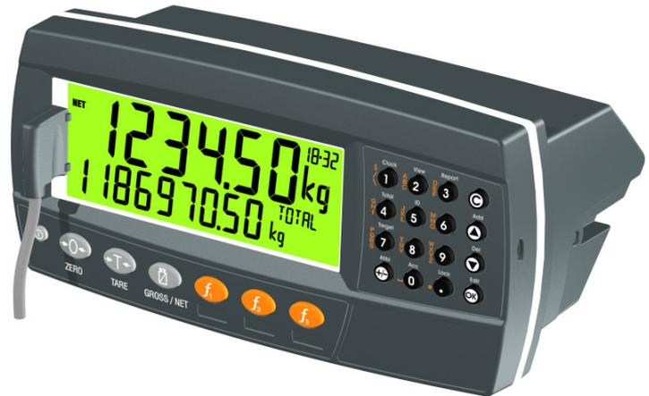
Das Kabelende am PC ist eine standardmäßige DB9 RS232 oder eine USB Anschlussbuchse. Das Kabelende ist auf der linken Displayseite der Wägeelektronik aufzusetzen.
